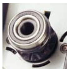
Wysokowartościowe okapturzone łożysko oraz panewka ślizgowa.
