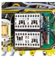
Sterowanie niskonapięciowe 42 V
